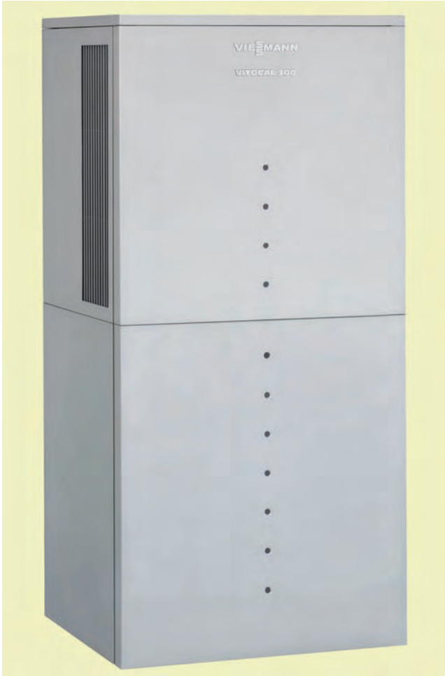
Abb. 1.13: Luft/Wasser-Wärmepumpe mit stufenlos regelbarem Verdichter, die nach Herstellerangaben eine Leistungszahl (COP) bis zu 3,8 und eine Vorlauftemperatur bis zu 60 °C erreicht und bis minus 20 °C einsetzbar ist. (Foto: Viessmann)
